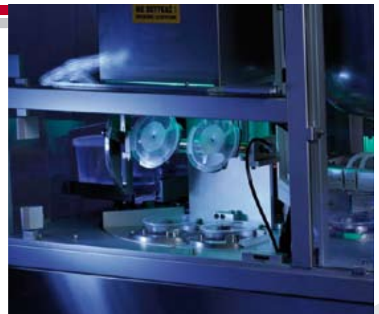
Station 3 Die Entnahme der sterilen Deckel und das Schließen der Becher
