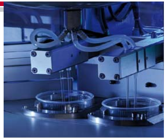
Station 2 Die Dosierung des Nährmediums/ Nahrungsmittels von einem Teflonbehälter direkt in den Becher
