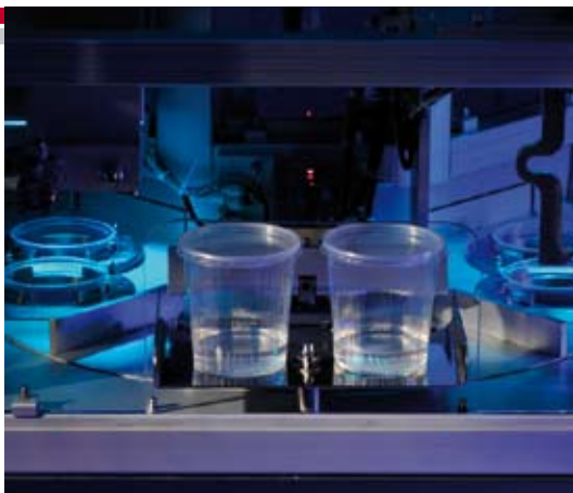
Station 4 Das Hinausbefördern der geschlossenen Becher auf ein Förderband
