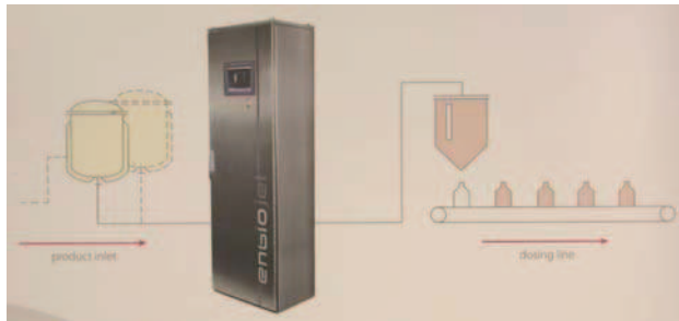
Processo di sterilizzazione del substrato e riempimento dei contenitori monouso basato sul sistema Enbiojet
